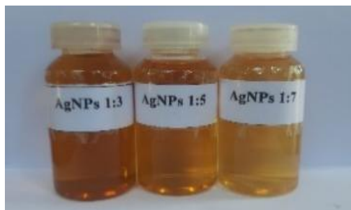
Gambar 1. Hasil sintesis AgNPs dengan perbandingan ekstrak dan \text{AgNO}_3
