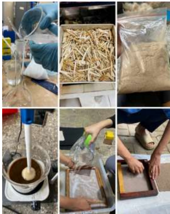
Gambar 1:Proses Pembuatan Kertas
