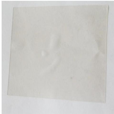
Gambar 2. Edible Film dari Batang Kelapa Sawit
