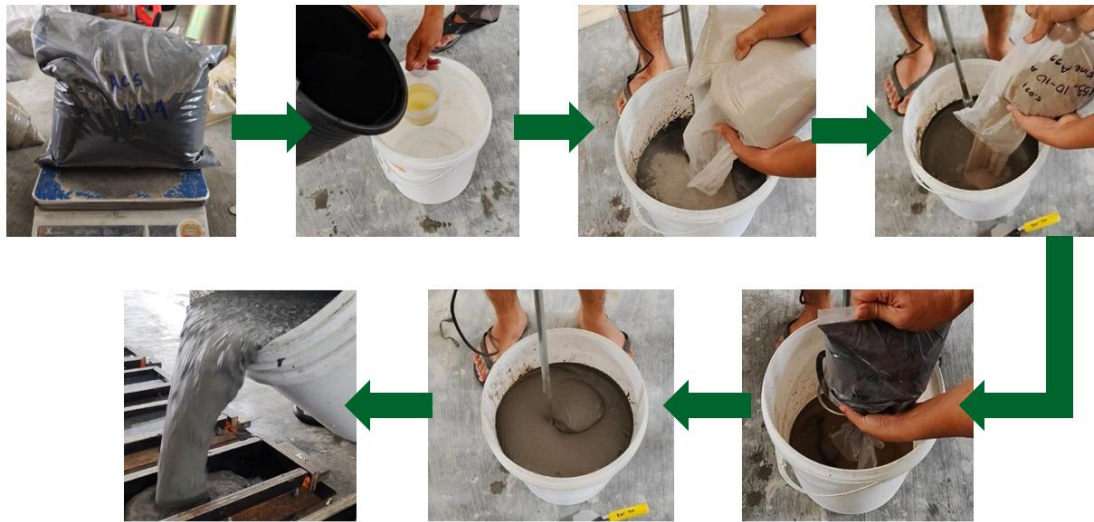
Gambar 6. Pembuatan benda uji bio fiber-ECC
