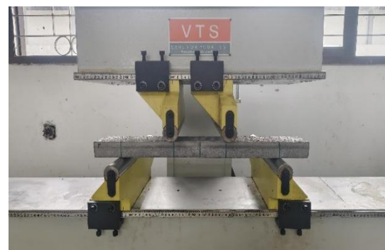
Gambar 2. Pengujian kuat lentur
