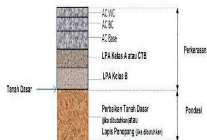
Gambar 1. Susunan Lapisan Aspal Beton
