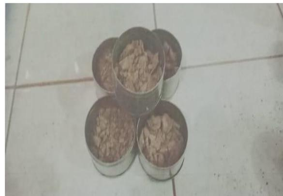
**Gambar 2. Sampel pengujian kadar air tanah**
