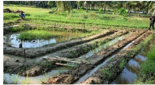
Gambar 9. Simulasi model saluran terbuka (Sumber: Dokumentasi peneliti)
