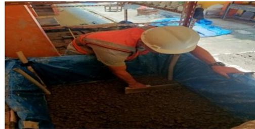
**Gambar 8. Pemadatan tanah lempung dalam bak uji.**
