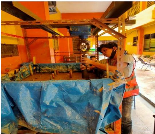
Gambar 10. Persiapan alat uji CBR
