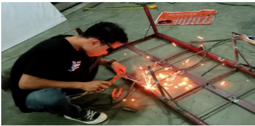
Gambar-4. Pekerja Las hanya memakai kaca mata tanpa APD yang lengkap
