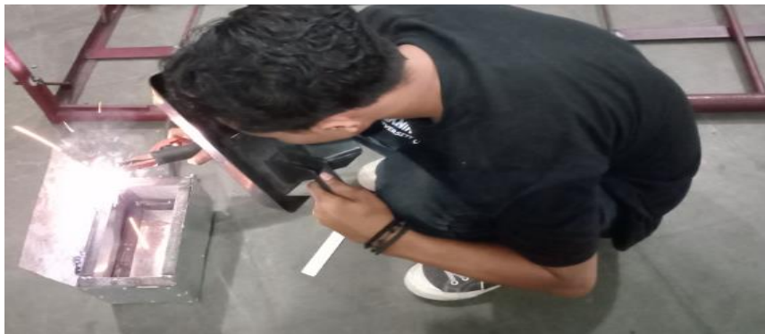
Gambar-5. Pekerja Las hanya memakai masker muka tanpa APD yang lengkap
