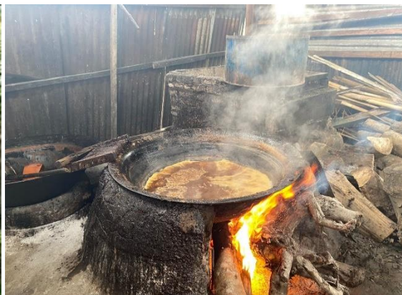
Gambar-2. Tungku tempat pemasak nira sawit
