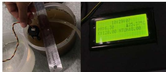
**Gambar 4.** Pengujian Sensor Turbidity pada air keruh
