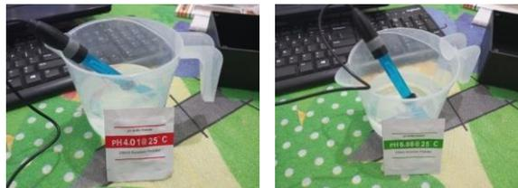
**Gambar 3.** Kalibrasi Sensor pH dengan pH Powder
