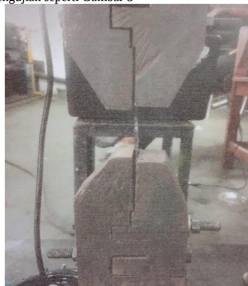
Gambar 3. Specimen knalpot cup 70 dengan cekam
