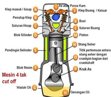
Gambar 5. Prinsip Kerja Motor 4 Tak.
