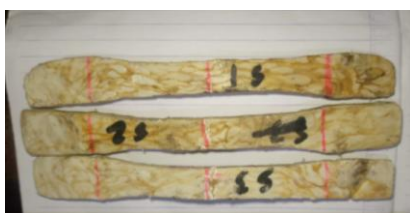
Gambar 5. Spesimen uji tekan
