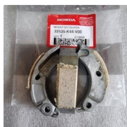
Gambar 4. Kampas kopling matic sebagai tenaga di sepeda motor (3)
