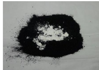
Gambar 5. Mencampur serbuk arang tempurung kelapa dengan Naturium Carbonat menjadi 3 bagian lalu diaduk dengan kantong pelastik selama 15 menit
