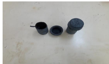
Gambar 6. Speciment yang telah dimasukan kedalam pack dicampur dengan serbuk arang tempurung kelapa dan Naturium carbonat .
