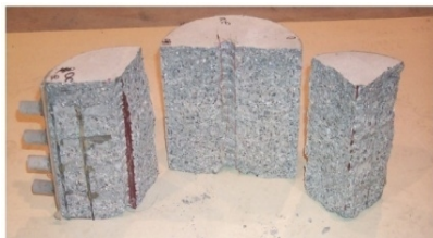
Gambar 3. Hasil simulasi kehancuran beton uji terhadap satuan waktu.
