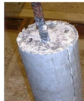
Gambar 4. Tulangan baja yang terdeformasi sebelum energi maksimum beton tercapai
