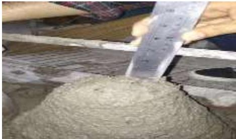
**Gambar 2. Pengujian Slump**
