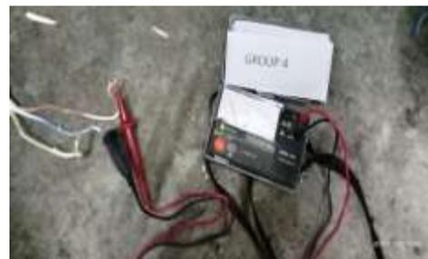
**Gambar 10. Pengukuran tahanan isolasi antara fasa R dengan netral (gruf 4)**
