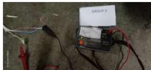
**Gambar 11. Pengukuran tahanan isolasi antara fasa S dengan netral (gruf 5)**
