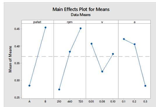
**Gambar 1. Data hasil perhitungan statistik respon dari Tebal Chip terhadap kondisi pemotongan.**
