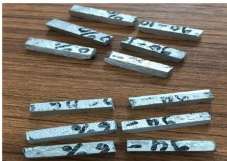
Gambar 4. Bentuk Patahan Uji Impact
