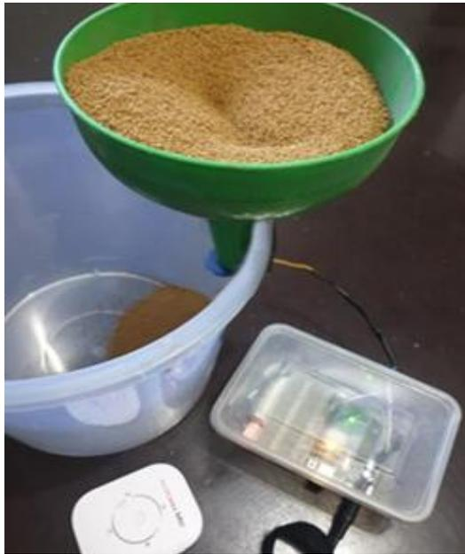
Gambar 6. Motor servo menutup katup
