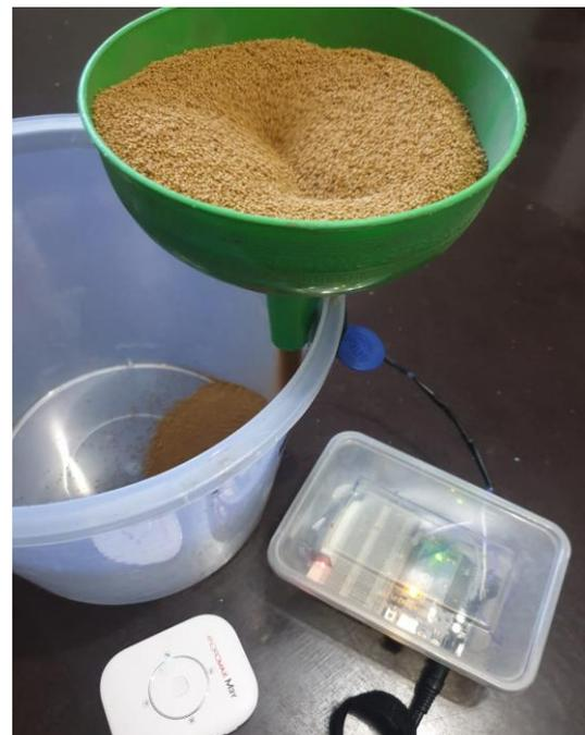
Gambar 4. Motor servo membuka katup
