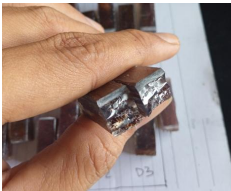
Gambar 2. Patahan Getas pada spesimen uji
