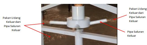
Gambar 1. Pakan Udang yang Keluar dari Pipa Saluran Keluar
