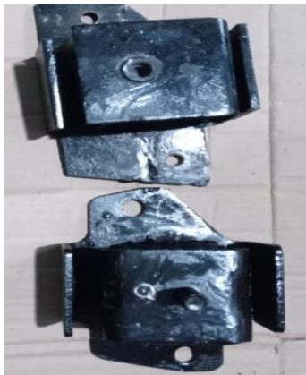
Gambar 3.3 Mounting dengan 4 per dan karet alam
