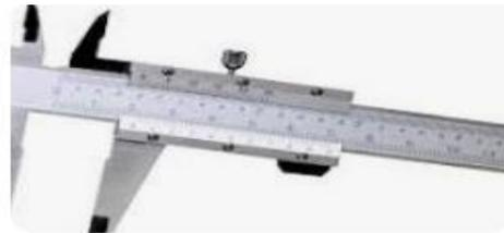
Gambar-4. Jangka Sorong memotong mengukur benda kerja
