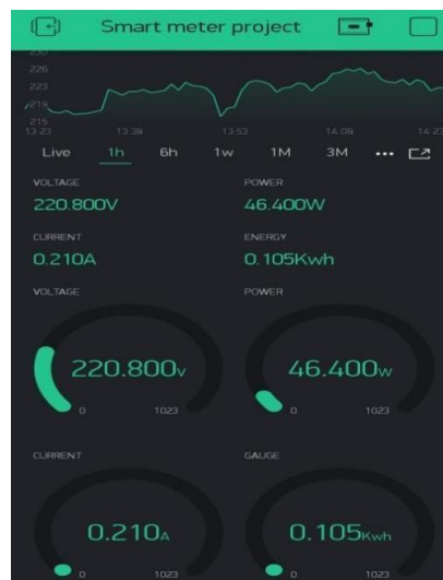
Gambar 8. Tampilan pada Aplikasi Blynk Rice Cooker Diberi Tegangan
