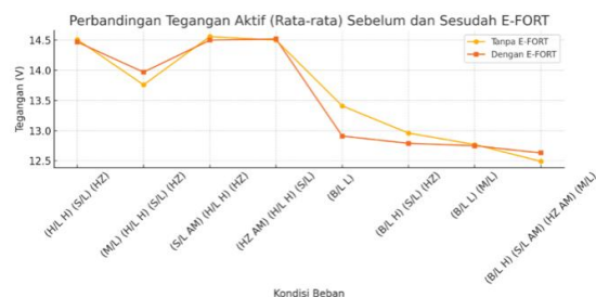
Gambar 8. Grafik Stabilitas Tegangan Terhadap Variasi Beban Kelistrikan Sebelum dan Sesudah Menggunakan Stabilizer
