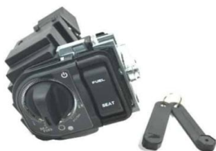
Gambar 6. Saklar Atau Kunci Kontak Sebagai Pemutus dan Penghubung Arus Listrik
