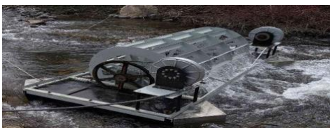
Gambar1. Pembangkit Listrik Tenaga MikroHidro
