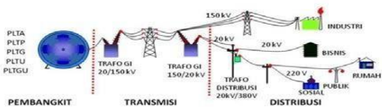
Gambar 1. Sistem Tenaga Listrik
