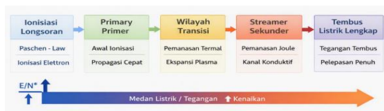
Gambar 6. Tahapan Breakdown Listrik di Udara
