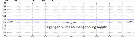
Gambar 23 a. Tegangan Input ( V_i ) Step-up Cuk Konverter
