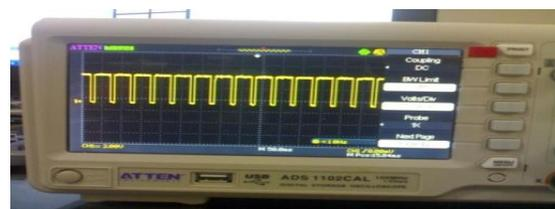
Gambar 11. Hasil Pengukuran Pulsa DC Chopper kecepatan ke-7 menggunakan osiloskop
