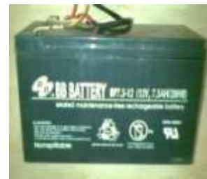
Gambar 9. Baterai Sekunder Model 12V,7.5/20HR
