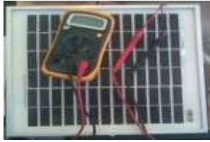
Gambar 16. Pengukuran Arus dan tegangan solar sel
