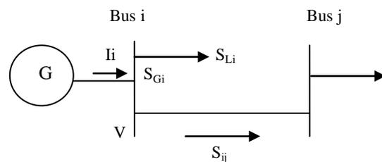
Gambar 1. Parameter Bus  $i$  dalam aliran beban
