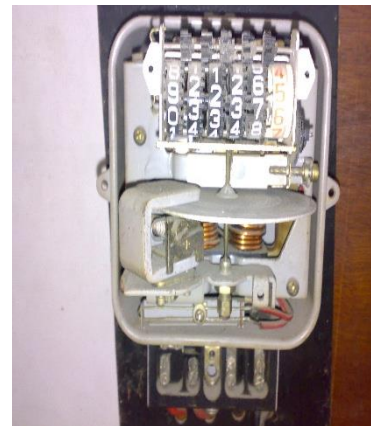
Gambar 1. Proses angka-angka yang muncul pada KWH meter
