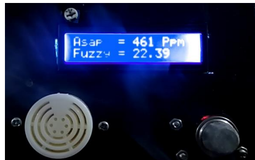
Gambar 21. Hasil uji asap pada pembakaran kertas
