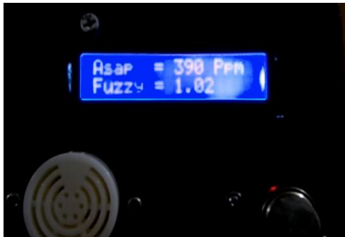
Gambar 18. Hasil uji asap pada asap rokok
