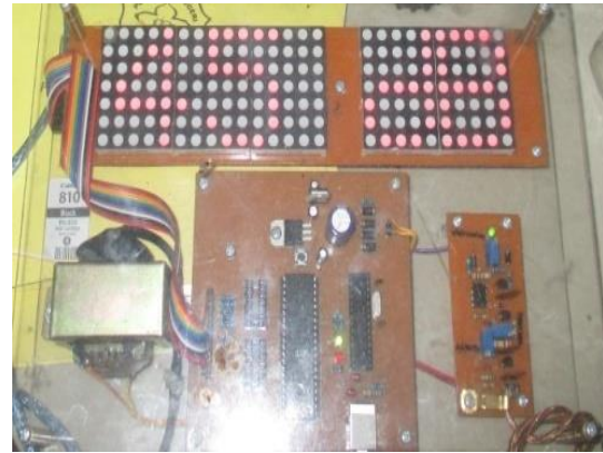
Gambar 5. Alat monitoring kebisingan berbasis mikrokontroler AVR Atmega 8535
