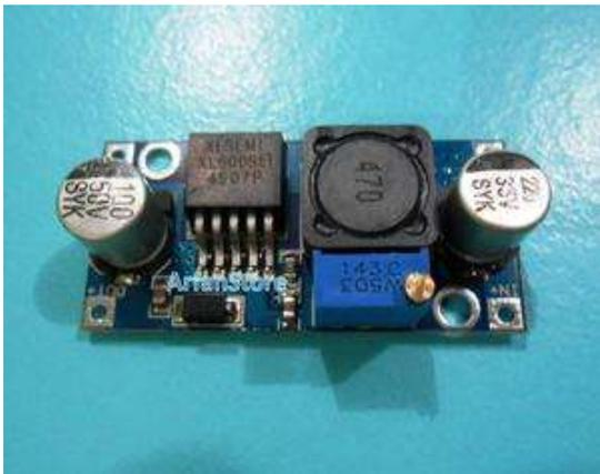
Gambar 12. Rangkaian DC/DCboost converter menggunakan XL6009
