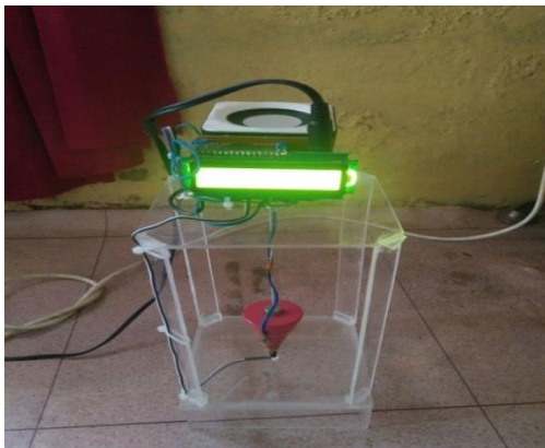
Gambar 8. Bentuk dari alat pendeteksi Gempa bumi selesai dirakit & diuji
