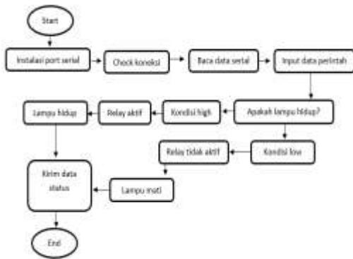
Gambar 4. Flowchart input perintah suara pada Arduino
