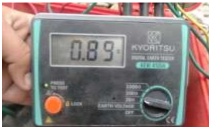
Gambar 25. Hasil pengukuran ketiganya diparalelkan
