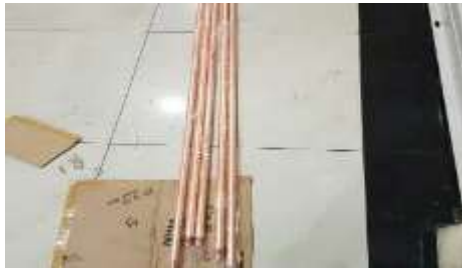
Gambar 3. Batang Tembaga untuk pentanahan
