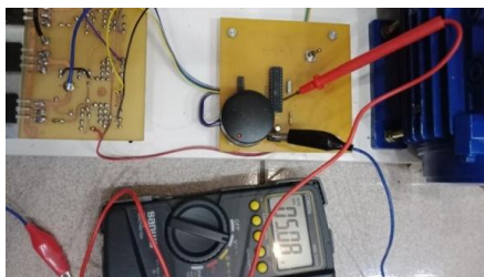
Gambar 11. Proses pengukuran step down dan penyearahan.
