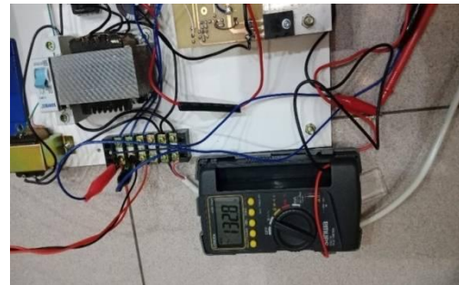
Gambar 12. Hasil pengukuran tegangan output inverter saat frekuensi rendah
