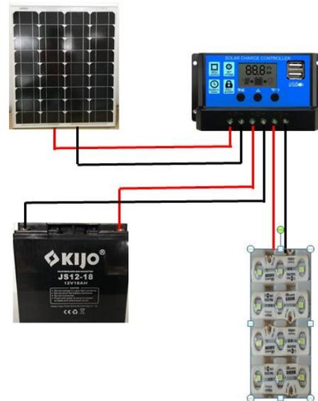
Gambar 4. Rangkaian Panel Surya dengan SCC
