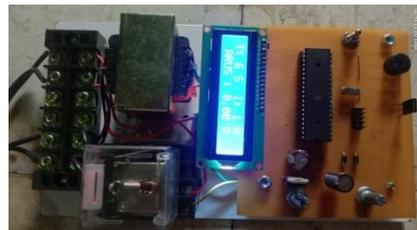
Gambar 6. Realisasi sistem over current rele berbasis mikrokontroler Atmega 8535
