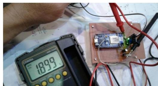
**Gambar 8. Pengukuran pada output sensor kelembaban**
