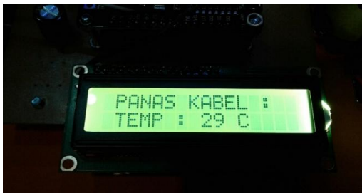
Gambar 11. Tampilan display LCD Temperatur Kabel yg Terdeteksi
