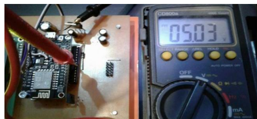
Gambar 10. Pengukuran Tegangan mikrokontroler Atmega 8
