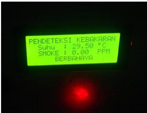
**Gambar 8. Hasil Pengujian Liquid Crystal Display (LCD) Menampilkan Teks**
