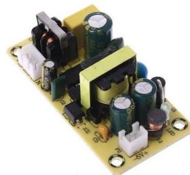
Gambar 3. Bentuk fisik power supply 5v dc
